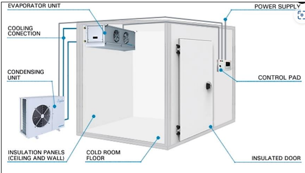
ภาพที่ 2 ส่วนประกอบพื้นฐานที่สำคัญโดยทั่วไปของระบบห้องเย็น
